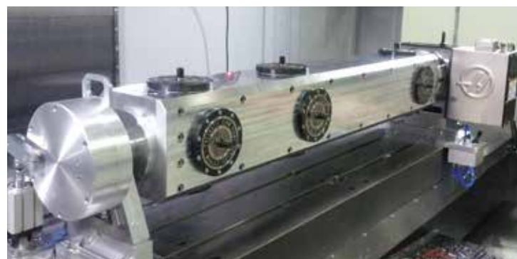
Attrezzatura speciale con Zero Point applicata su tavola girevole HAAS Special aluminum Zero Point fixture on HAAS rotary table
