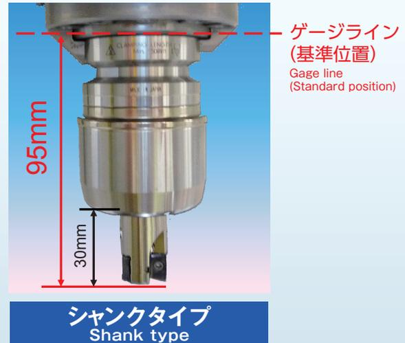
モジュラータイプはシャンクタイプに比べ、同じ突出し長さにもかかわらず、刃先からゲージラインまでの距離が短い
