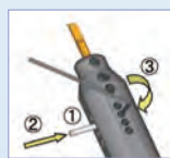
図1 位置決めピン装着方法 Fig. 1: How to use adjustment pin
